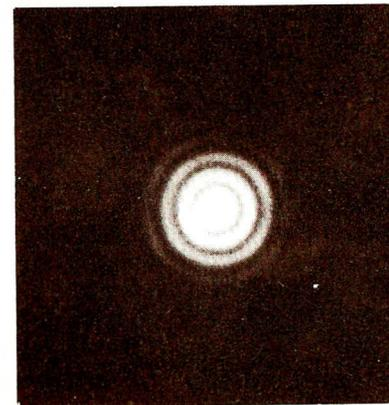
Fig. 23-12. Diagrama de difracción de Fraunhofer de una abertura circular.
