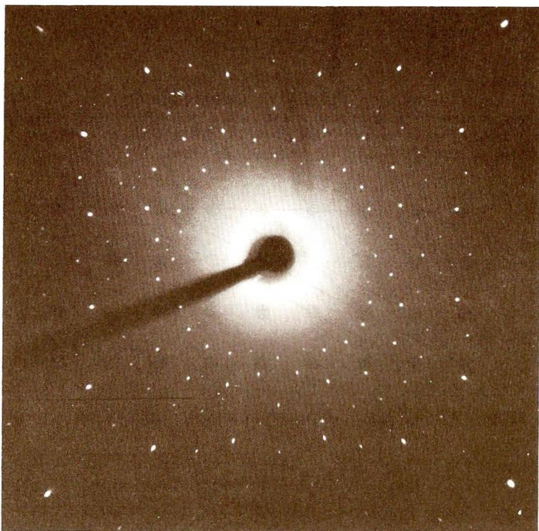
Fig. 23-40. Diagrama de Laue de difracción para un cristal de cuarzo. Se ha intentado disimular el efecto del haz incidente no desviado.
